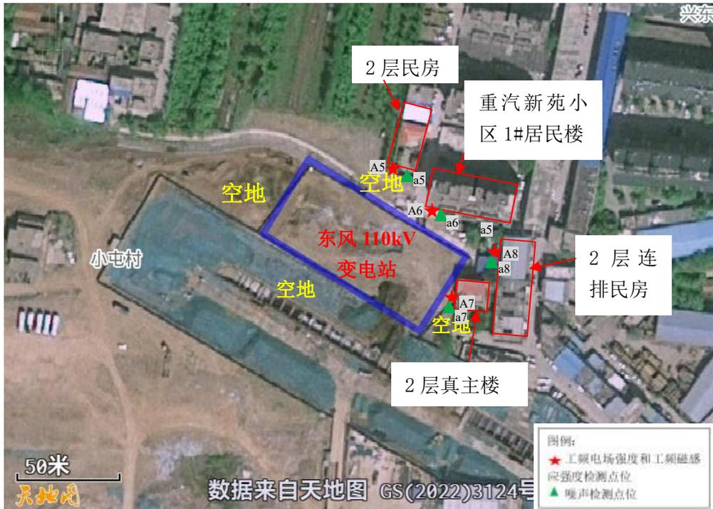
图 4-2 东风 110kV 变电站周围关系影像图及检测布点示意图
