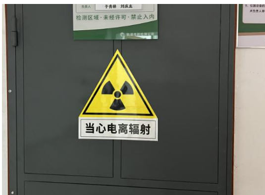
X 射线探伤机设备库防护门电离辐射 警告标志
