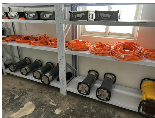
X 射线探伤机设备库
