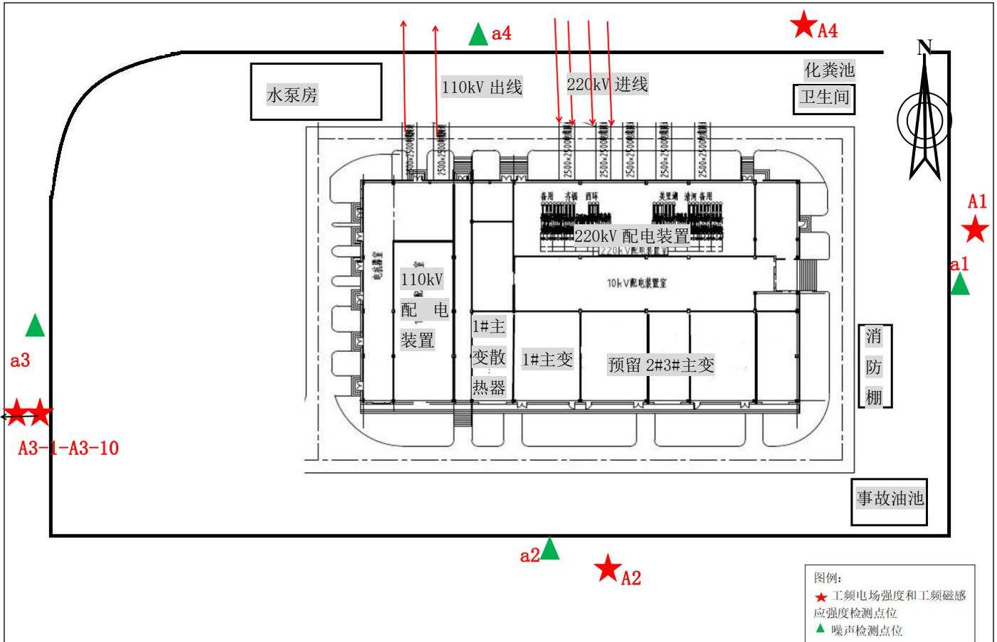
图 4-9 玉湖 220kV 变电站平面布置及检测布点示意图
