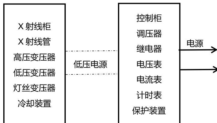
图 2-5 X 射线探伤机结构组成
